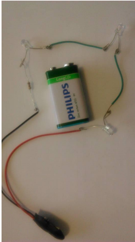
FIGURA 2 – Bateria, fios condutores, conector de bateria, LEDs. (Fonte: AUTOR 2016)
